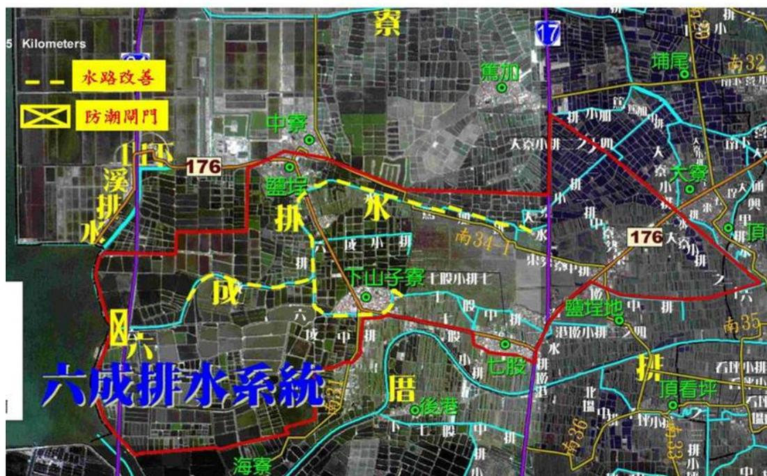
圖 7.3-30 六成排水系統方案四工程佈置示意圖
