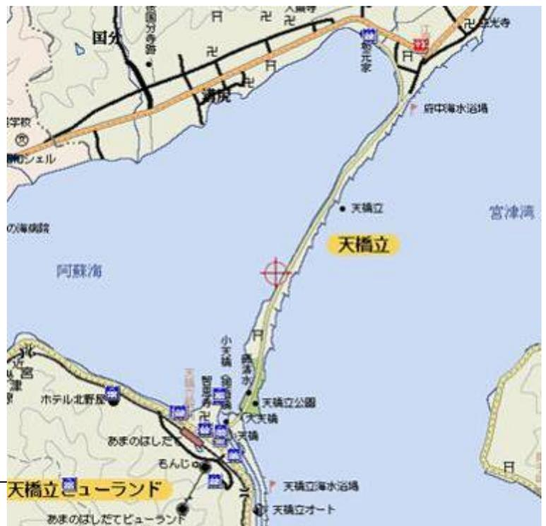
(Hioki) 及江尻 (Ejiri) 兩處漁港相繼擴建，又因航道疏濬，幾乎完全攔截南下的沿岸漂沙，明顯地加速天橋立砂洲的侵蝕，致沿砂洲主體的寬度退縮到 20 至 170 公尺不等。京都府會同中央主管海岸機關，於 1950 年左右，以每隔 50 公尺的間距築造多座 15 公尺長的短突堤群，以保護天橋立海岸，但積沙成果不彰。到 1970 年左右，再把每第四座突堤的長度加倍，以增加攔截的漂沙與砂洲的寬度；這種措施雖可遏止海岸侵蝕，卻不能恢復原有天然的美景 (Yajima et al., 1983; Irie, 1990)。當時曾有建造離岸堤群與潛堤之建議，但未被採納實施。到 1982 年，主管機關改採「土沙側渡」(Sand bypassing) 法，每年由日置及江尻兩漁港濬挖土沙 4,000 立方公尺，以駁船載運到砂洲最北端外海處海拋，讓波浪的自然力把土沙送上岸邊，由北往南堆積在突堤群之間；再適時於砂洲下游收集過量的土沙，載運到上游海拋點，再循環 (recycle) 運用。這種以突堤群、養灘、「土沙側渡」及再循環運用的綜合工法，實施多年以來，確實能達成保護天橋立砂洲的目標。
