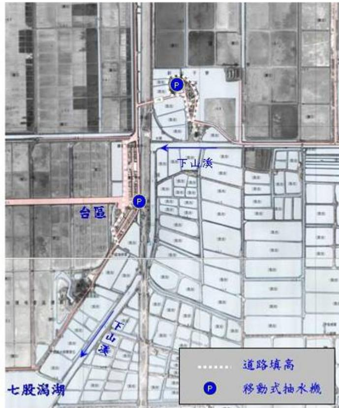
圖 7.3-20 大寮排水系統方案四聚落淹水改善平面佈置示意圖
