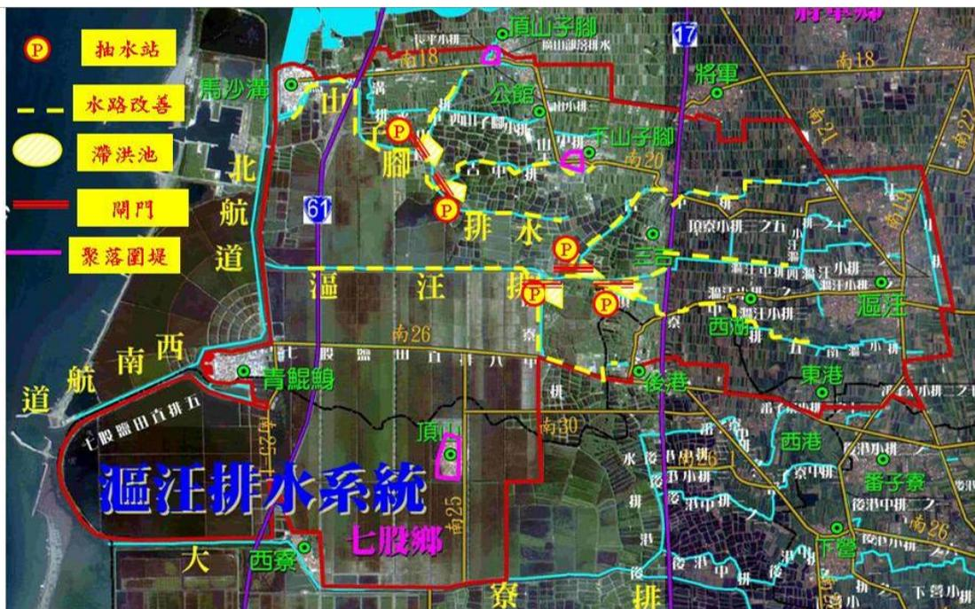
圖 7.3-5 滬汪排水系統方案二工程佈置示意圖
