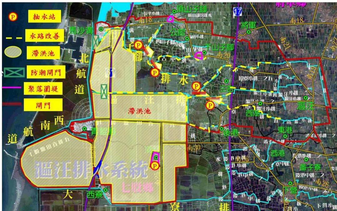
圖 7.3-7 漚汪排水系統方案三工程佈置示意圖
