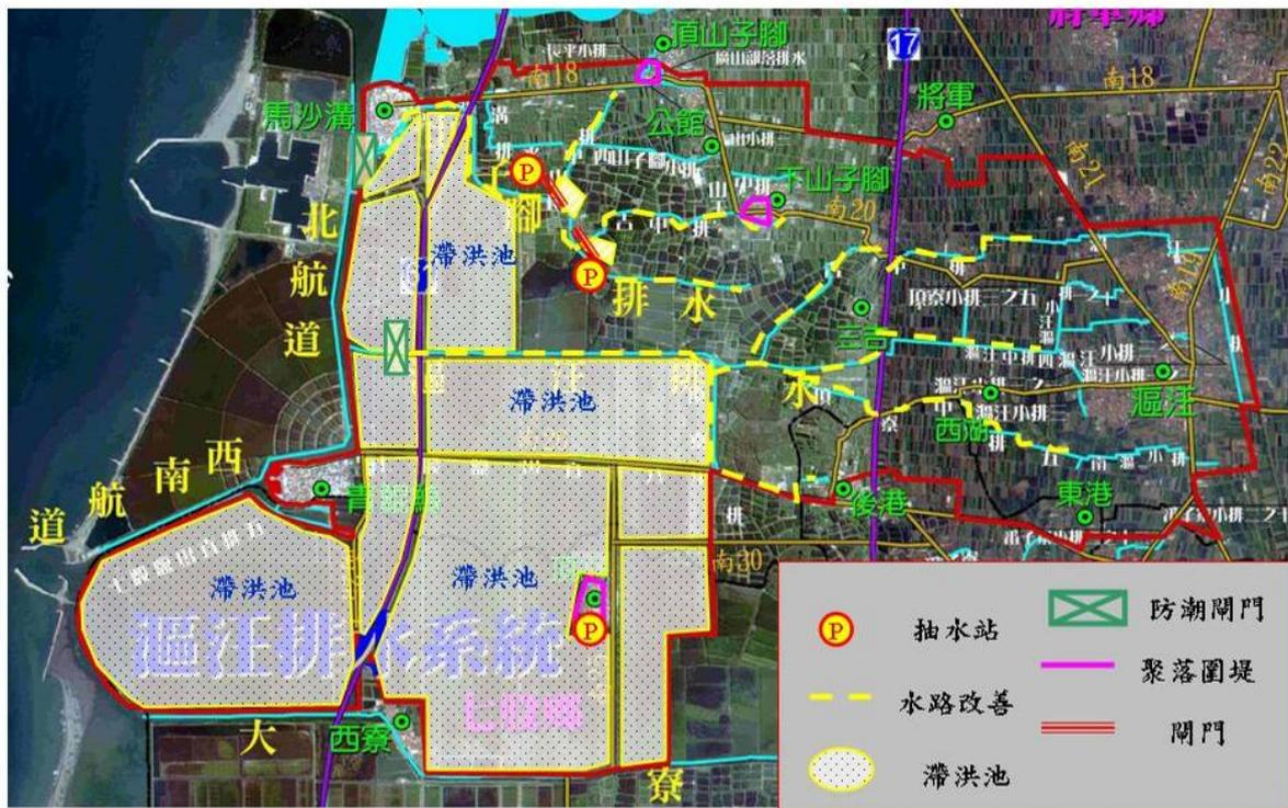
圖 7.3-10 滬汪排水系統方案四工程佈置示意圖
