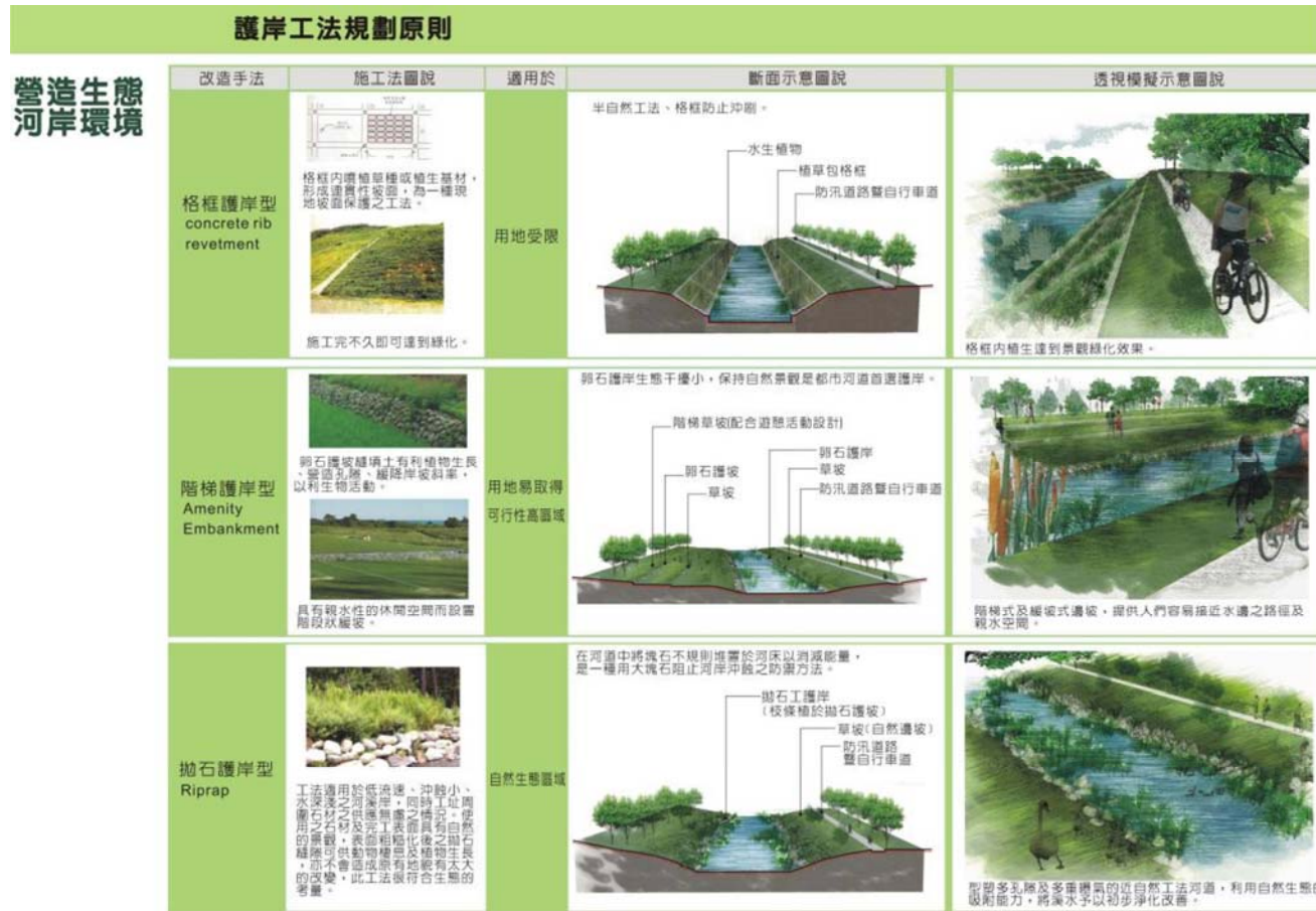
圖 8-8 水域護岸工法環境營造說明圖
